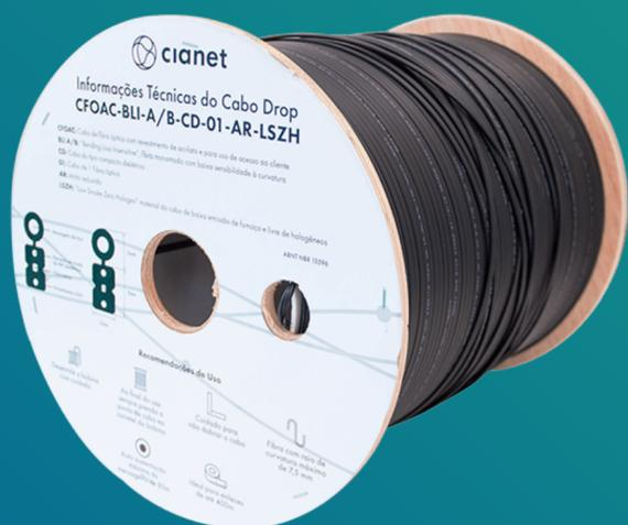
O Cabo Drop de Fibra Óptica é recomendado para estruturar redes FTTx, para acesso ao assinante. Possui fibra monomodo com baixa sensibilidade a curvaturas (G.657A) e os elementos de tração são constituídos de material FRP (dielétrico). Possui proteção LSZH, o que retarda as chamas em caso de incêndio e não emite poluentes tóxicos.
